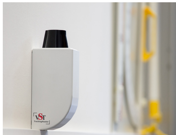
Einer von drei LiDAR Sensoren (Laserscanner)
